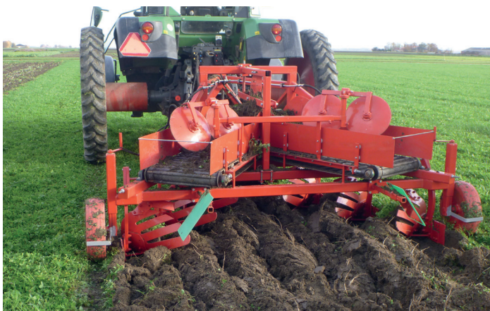
Figuur 1 | Prototype nieuw ontwikkelde beddenploeg voor ondiep ploegen in vaste rijpaden.
